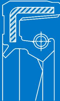
El perfil TFW es un retén de doble labio compuesto de una única jaula de metal con un revestimiento de goma reforzado, para evitar la corrosión, un labio de sellado primario con muelle integrado y un labio guardapolvo que actúa de protector contra la acumulación de suciedad desde el exterior. El labio de estanqueidad tiene estrías con un sentido de rotación bidireccional, para seguir el mismo giro del eje y controlar la expulsión de lubricante.
